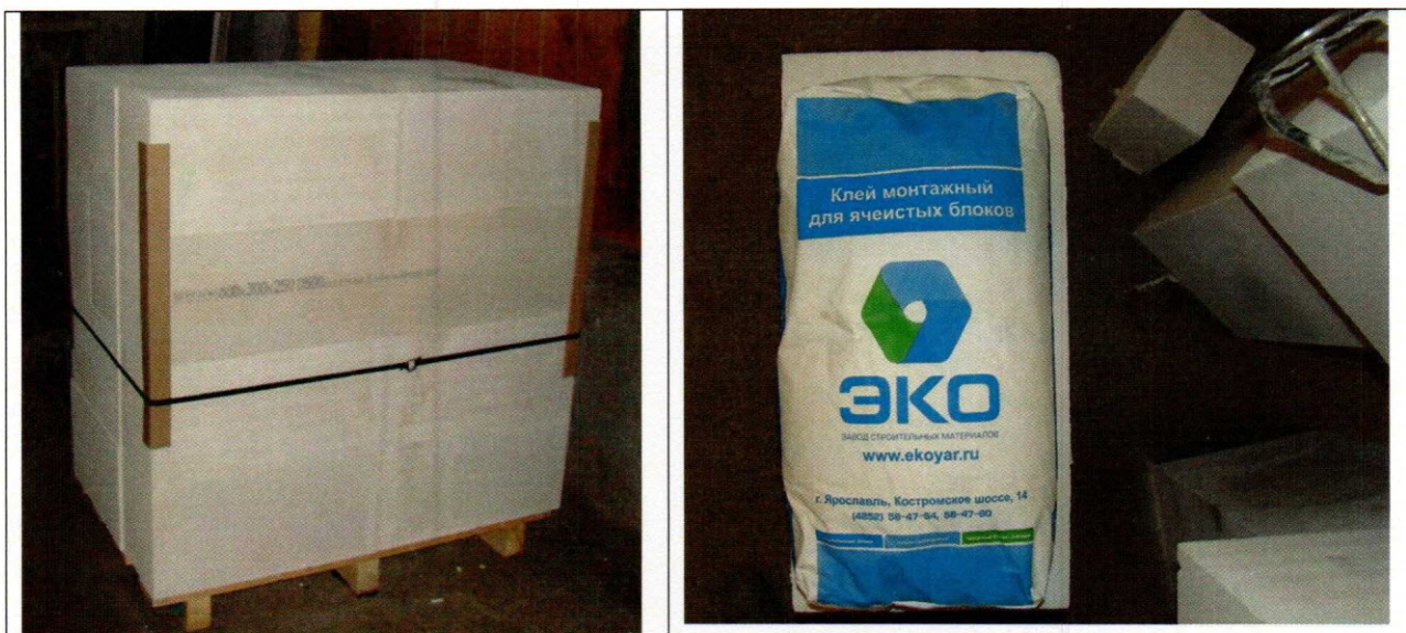
Рис. 1. Образцы блоков стеновых неармированных из ячеистого бетона автоклавного твердения БСМІ600*250*300D500В2,5F75 ГОСТ 31360-2007, а так же клей монтажный, представленные для проведения экспериментальных определений теплопроводности в кладке.
