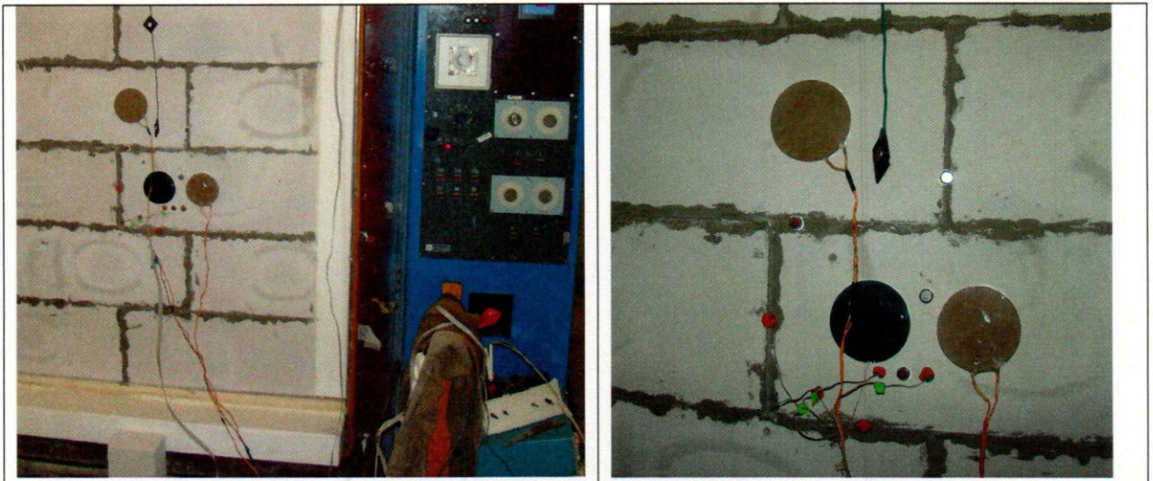
Рис. 3. Проведение экспериментальных определений теплопроводности в кладке блоков из ячеистого бетона автоклавного твердения на клею
