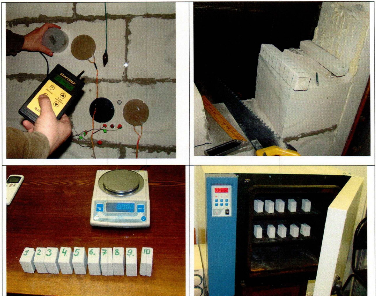
Рис. 4. Контроль влажности кладки в процессе эксперимента осуществляли посредством прибора ВСКМ-12У. По окончании эксперимента, провели отбор проб материала по толщине конструкции для определения средней влажности кладки.
