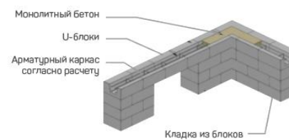
Схема изготовления армопояса из U-блоков «ЭКО»
